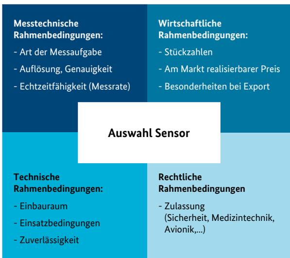
Abbildung 5: Rahmenbedingungen bei der Auswahl von Sensoren (beispielhaft)
