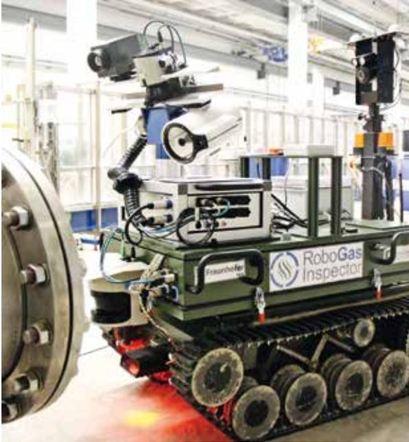
Der RoboGasInspector erkennt frühzeitig Gaslecks in technischen Anlagen
