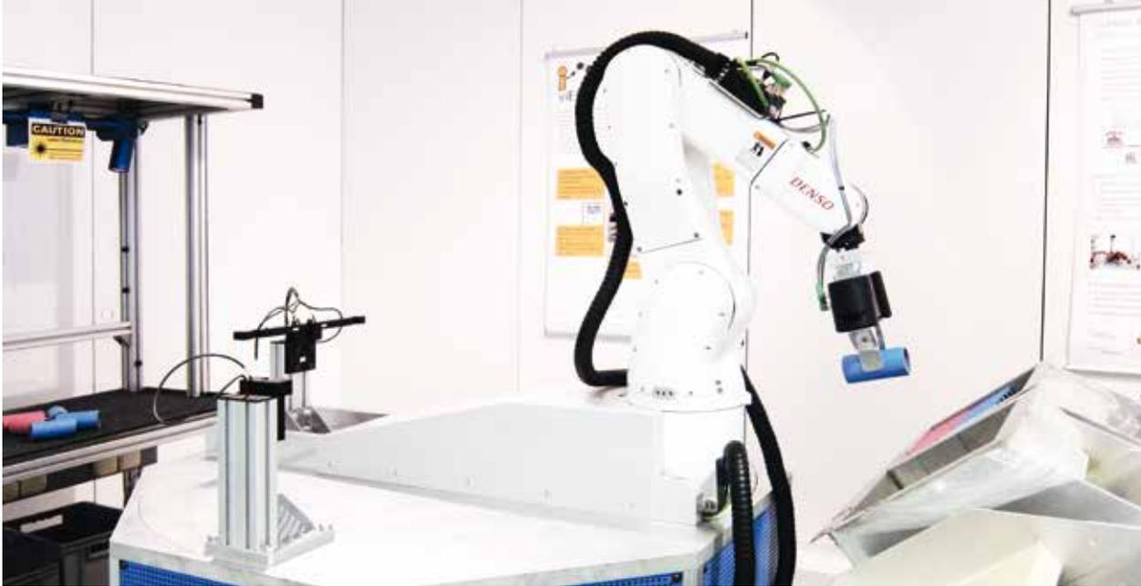
Der Roboter legt ein Werkstück selbständig an einer vorgegebenen Position ab (viEMA).
